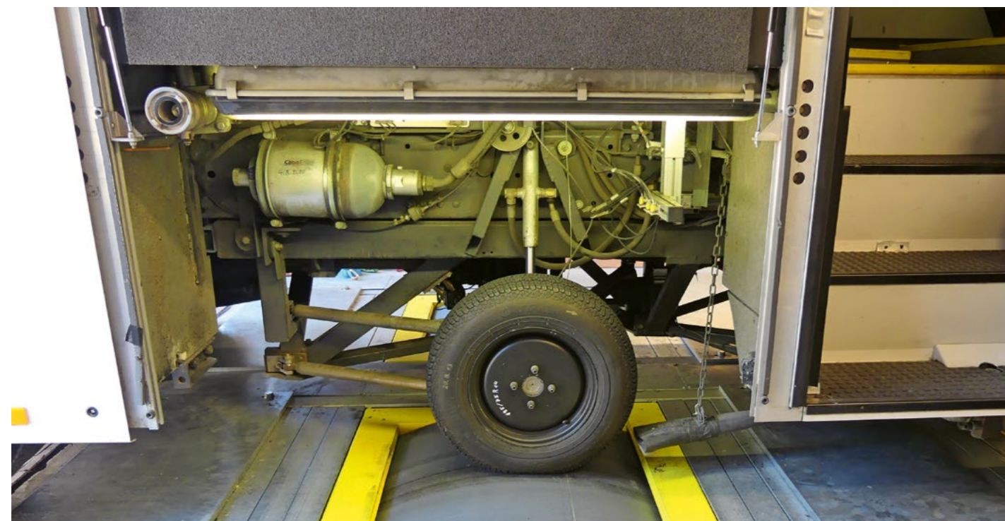
La Haute école spécialisée bernoise a étudié les pneus et leur abrasion, d'abord sur le banc d'essai à roue, puis sur la route avec le laboratoire de pneus en mouvement. Photo: BFH
