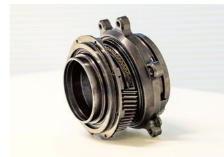
Au moyen d'un moteur électrique, la denture du prototype Lamborghini permet de régler le moyeu des roues pour des valeurs de carrossage variables. Photo: Lamborghini
